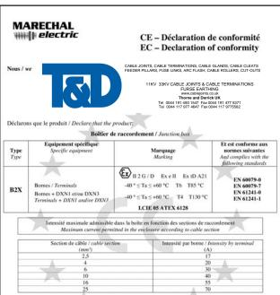
avec les caractéristiques d'étanchéité suivantes / with the following watertightness characteristics: IP66/IP67
